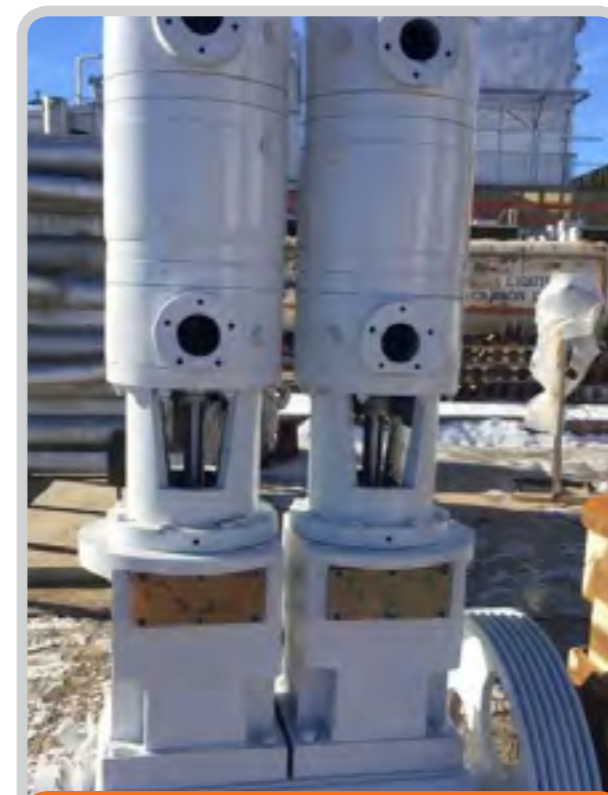
کمپرسورهای ساخته شده برای فاز ساخت واحد غشایی و بهره‌برداری طرح
